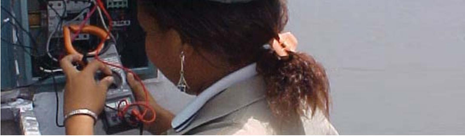
La sensibilidad del diferencial se establece en 30 mA ó 0,03 A para bases de corriente; y 300 mA ó 0,3 A para equipos fijos no desplazables en tensión.
