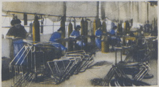
Sin detenernos en las secciones de lima, embutizaje, mecánicas y de soldadura al «brasage», contemplemos un ángulo del departamento de soldadura autógena.
