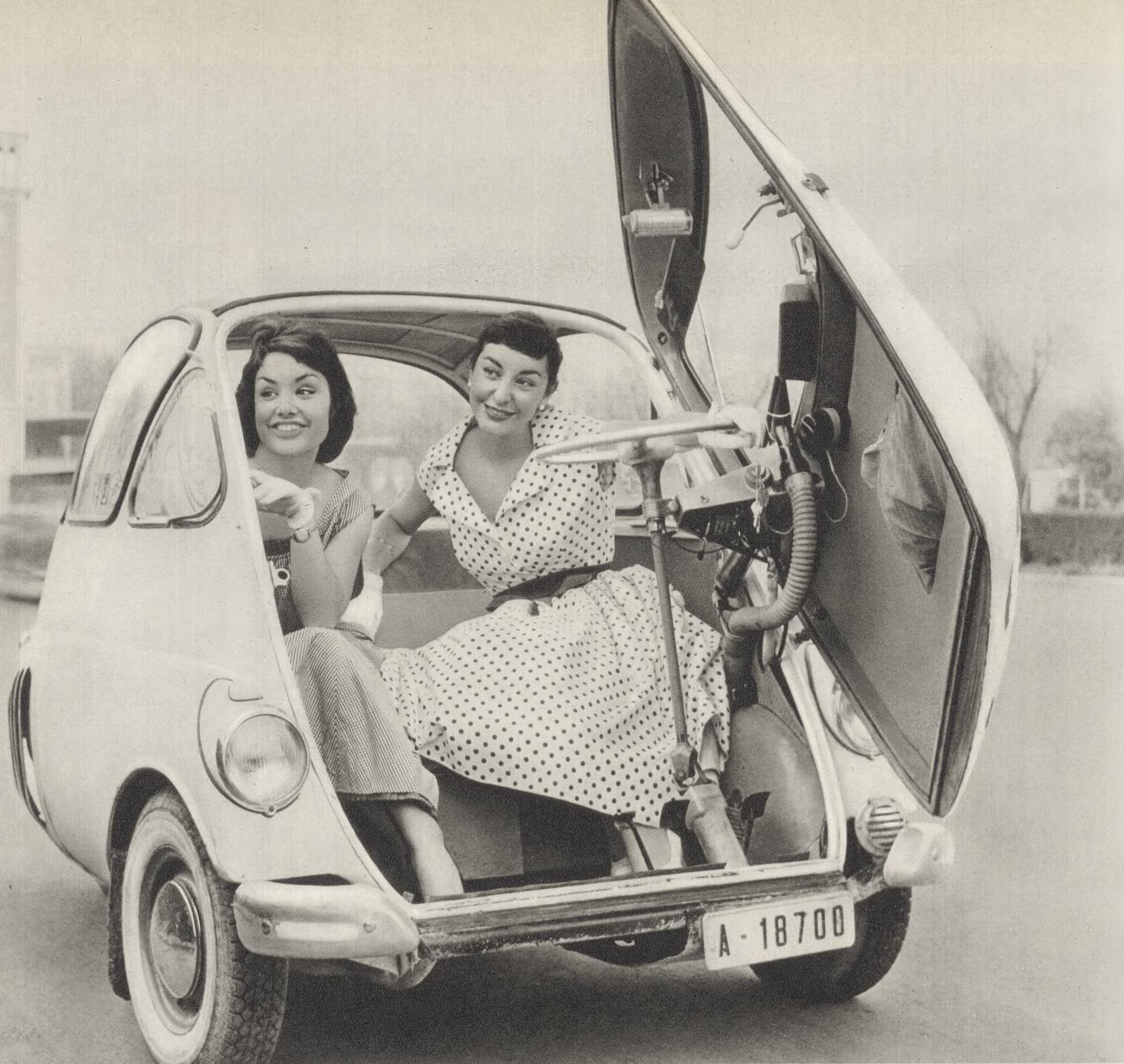
Abajo.—COCHE: El biscuter «Voisin», fabricado asimismo en Barcelona. Tiene un solo cilindro, con 197 c. c. de cilindrada y 5.800 revoluciones por minuto. Su potencia fiscal es de dos caballos y la efectiva de nueve. Lleva tres marchas adelante, más la marcha atrás, y tiene la palanca de cambio bajo el volante. Su longitud es de 257 centímetros, con una anchura de 121. Asiento para dos o tres personas. Consume 4,5 litros por cien kilómetros y alcanza una máxima de 76 kilómetros por hora. MODA: Modelo «Primavera», en vichy de cuadritos blancos y negros, con apliques en rojo en el escote y en los bajos de la falda.
