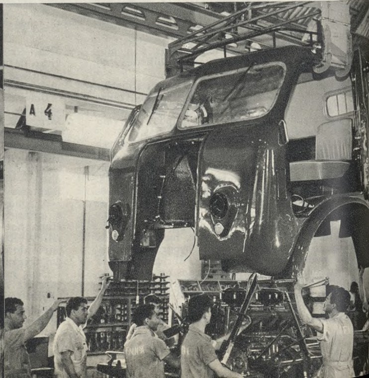
Linha de montagem. Colocação da cabina.
