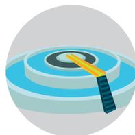
**Sedimentación:** reduciendo la velocidad del flujo, las partículas sólidas pequeñas se decantan al fondo del tanque. El agua de la superficie sin sólidos es transportada al siguiente componente del tratamiento y se denomina efluente.
