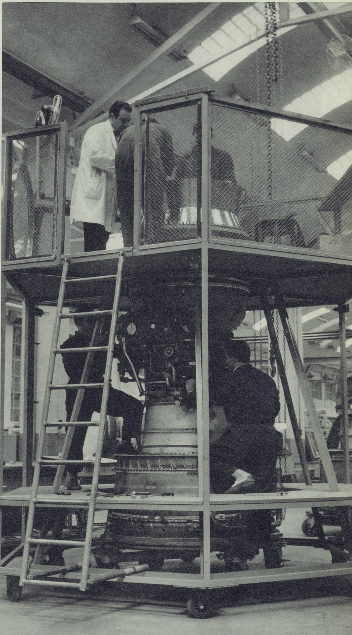
El tamaño y el peso del motor requieren instrumentos de trabajo como esta torre, dentro de la cual se instala antes y después de ser desmontado.
