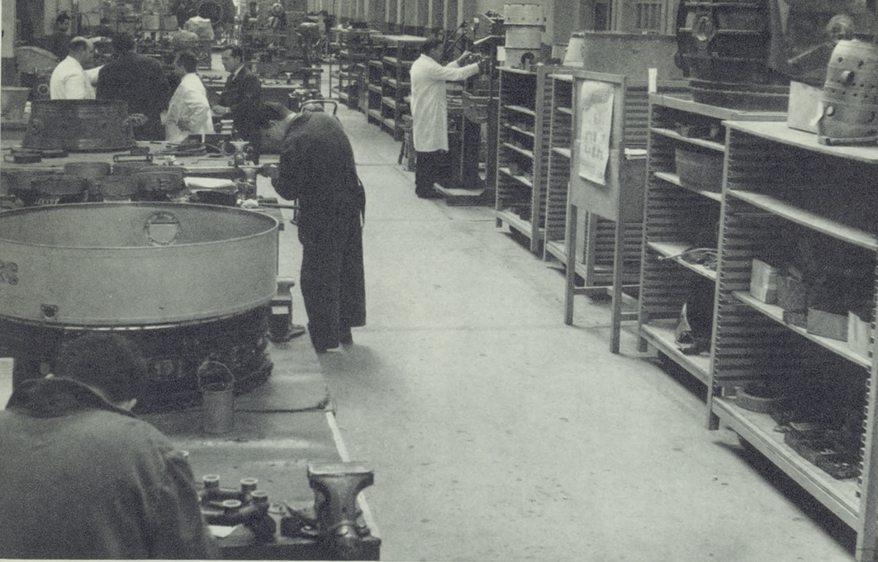
▲ Vista general del taller de motores. A lo largo del banco van siendo desmontados, y en los estantes de la derecha se depositan las distintas partes, clasificadas y numeradas. El motor es el órgano fundamental en la aviación de todo el mundo. Este de Iberia pesa unos 2.000 kilos y vale 20 millones de pesetas. ▼
