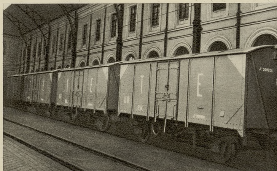
Tren puro de material metálico, frenado, para el transporte de abastecimientos.
