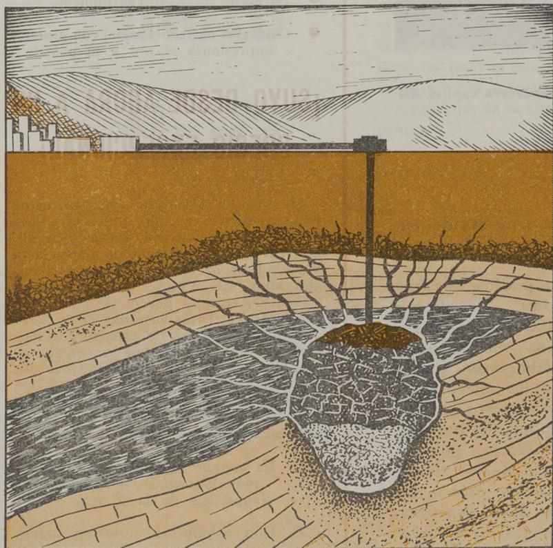
En el dibujo de la izquierda se registra la explosión atómica para recuperar petróleos y alquitranes gruesos profundizados en lechos que no pueden minarse por los medios habituales. Y en el de la derecha se trata de un método de control de agua en que la explosión excava un gran depósito para alma-
