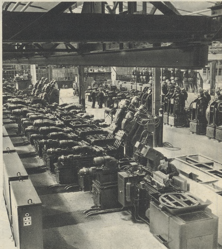
Una de las máquinas automáticas construídas por la Casa Renault para la fabricación de motores. Algunas de estas máquinas alcanzan hasta 30 metros de longitud y realizan la labor de 28 puestos de trabajo, con 36 cabezas electromecánicas que accionan más que 200 herramientas.
