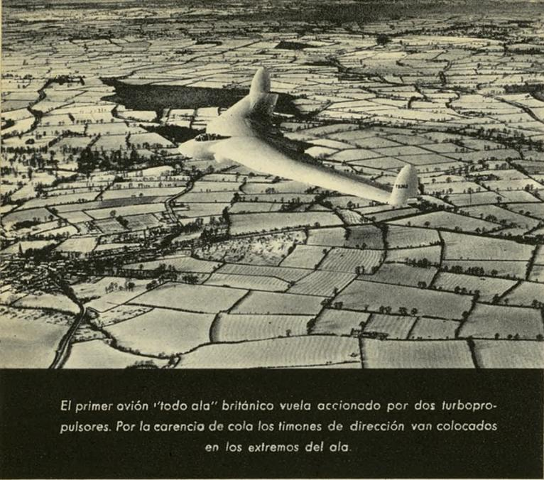
El primer avión "todo ala" británico vuela accionado por dos turbopropulsores. Por la carencia de cola los timones de dirección van colocados en los extremos del ala.
