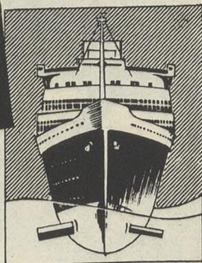
El objeto del "estabilizador" es lograr que, con el mar en malas condiciones, el movimiento del buque quede reducido a un mínimo. Consiste en dos aletas de forma parecida a las alas de un avión, colocadas a cada costado del buque bajo la línea de flotación y controladas automáticamente por giróscopos, que determinan el momento en que las aletas tienen que actuar y la inclinación necesaria para contrarrestar el balanceo que produciría el oleaje.
