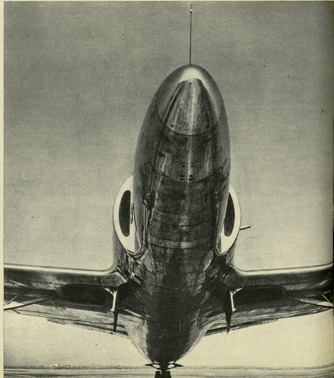
Arriba: La hélice desaparece en el moderno avión. El hueco que observamos sirve para la toma de aire que facilita el funcionamiento de la poderosa turbina.—Abajo: El Vickers "Attacker" exhibe en esta foto la extraordinaria pureza de sus líneas. Este avión conquistó un "record" de 909 kilómetros por hora sobre un circuito de 150 kilómetros.
