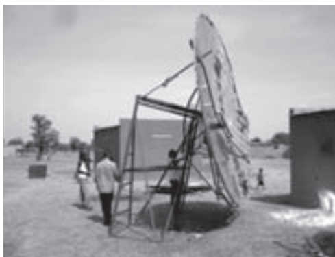
FOTO 1. PARÁBOLA SOLAR TÉRMICA PARA EL PROCESADO DE KARITÉ. FABRICADA POR ISOMET EN DABARÉ. BURKINA FASO. FOTOGRAFÍA DE GREGORY MILLER. SNV.
