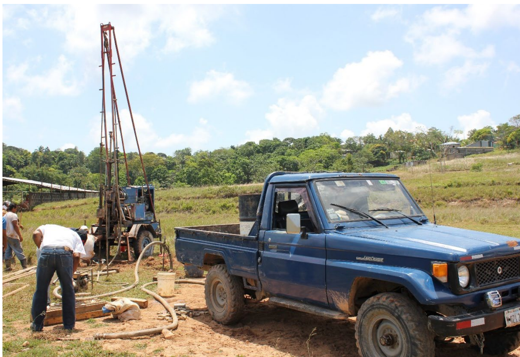
Figura 15 Estudio geotécnico en uno de los terrenos evaluados para la PTAR de Bluefields (Nicaragua).
