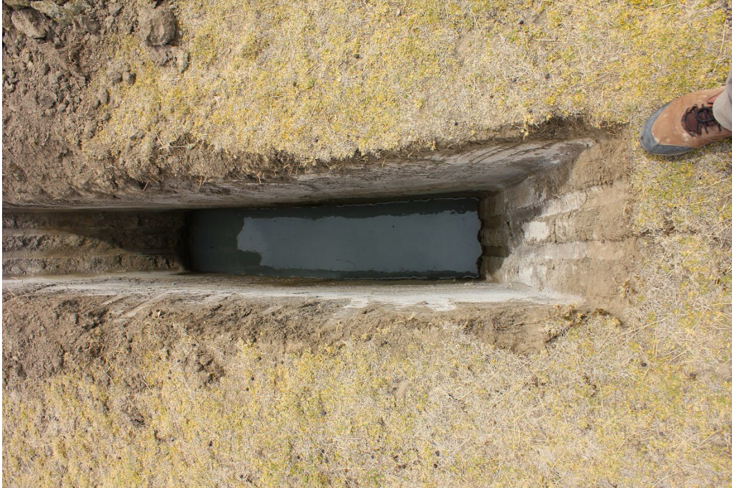
Figura 24 Cata realizada en los terrenos de las PTAR de Warisata (Bolivia), donde se puede apreciar el nivel freático somero.
