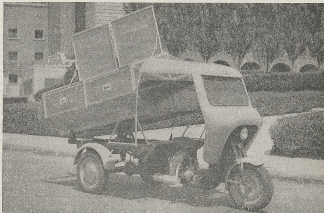
El Motocarro AVIA 200, fabricado por Aeronáutica Industrial, S. A., en tres de sus múltiples aspectos y aplicaciones
