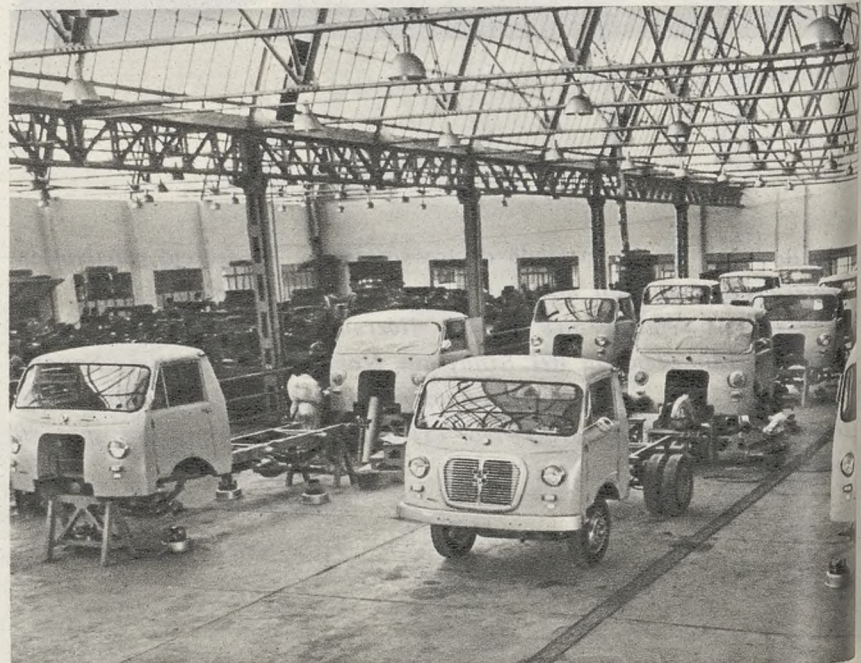
De izquierda a derecha, un primer plano del camión ligero Aeronáutica Industrial, 2.500 Diesel, sin la caja, y una vista parcial de una de las naves de montaje
