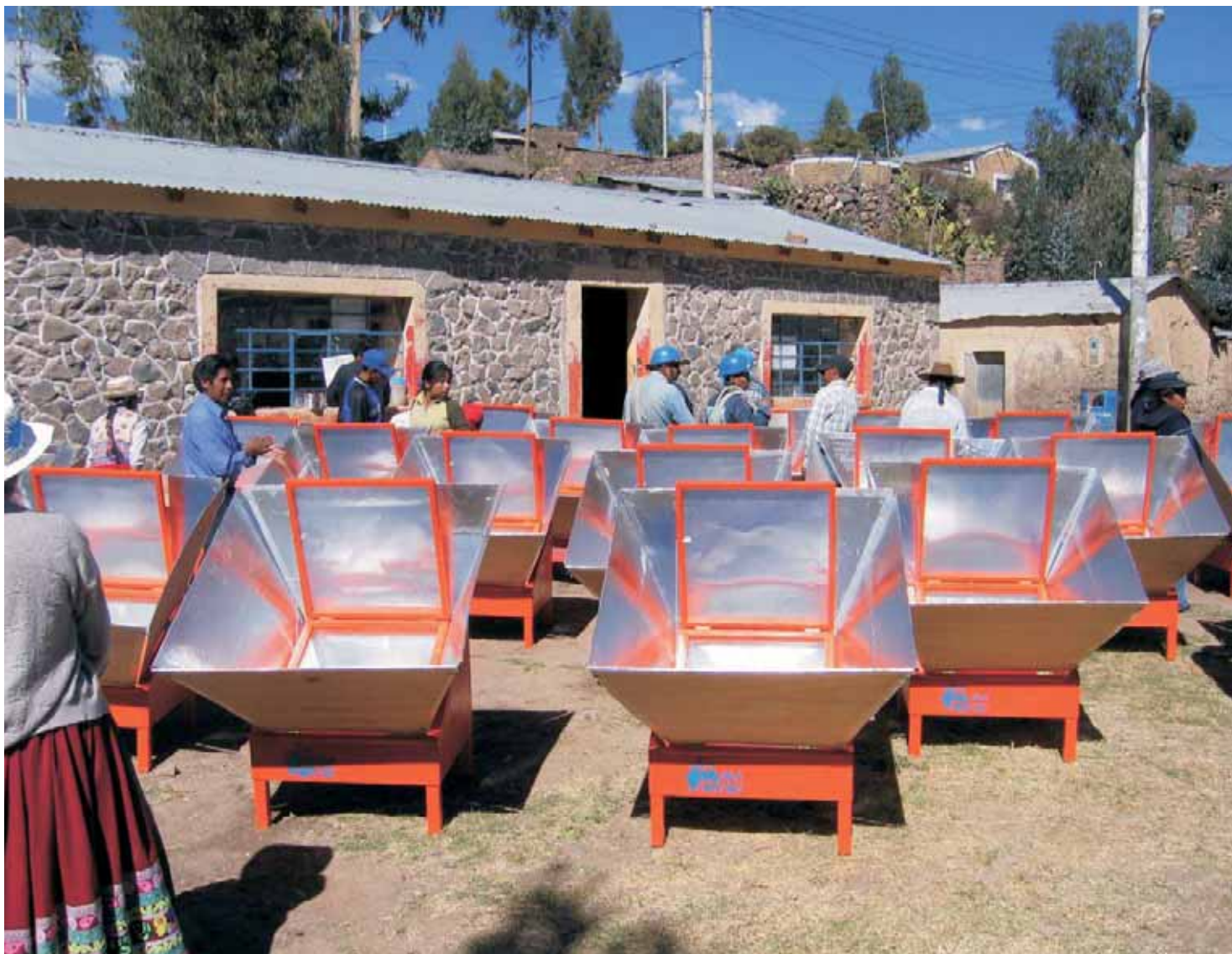
Cocinas solares fabricadas por los propios pobladores
