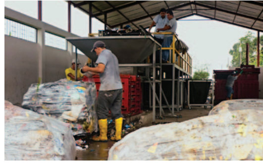
Foto IPADE. Proceso de enfiambre de los desechos, previo a trasladarse al relleno sanitario.
