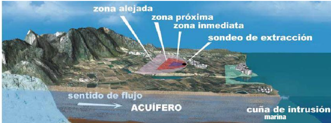
Esquema de los diferentes perímetros de protección de la calidad del agua subterránea, en un pozo destinado al abastecimiento urbano
