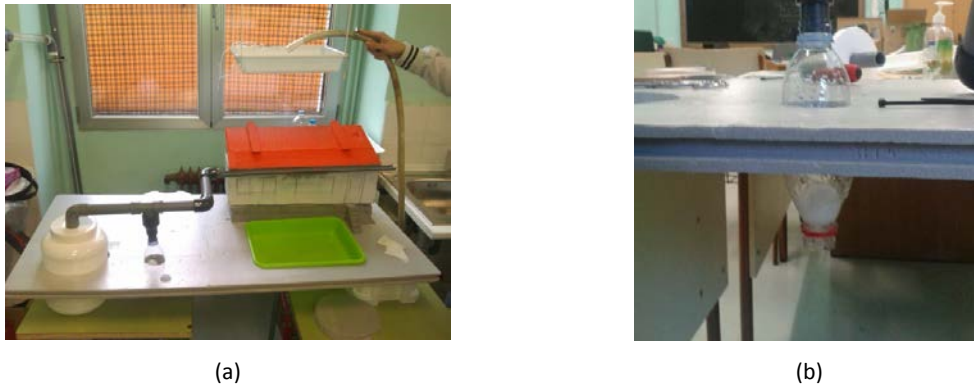
Figura 26. Fotos de la maqueta Sistemas de Recogida de agua de lluvia realizada en el Laboratorio de hidráulica aplicada al Desarrollo (Universidad Politécnica de Madrid): (a)- Maqueta del Sistema y (b)- Foto del dispositivo automático de retirada de primeras agua
