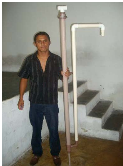
Figura 13. Bomba de émbolo de PVC premontada
