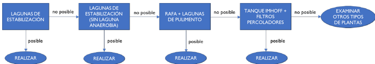
Figura 5. Ejemplo de proceso de selección de alternativas mediante árboles de decisión (Wagner, 2010)
