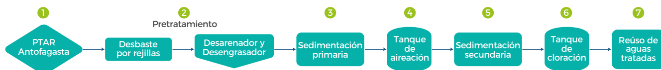
Figura 3: Proceso de tratamiento de la PTAR Antofagasta
