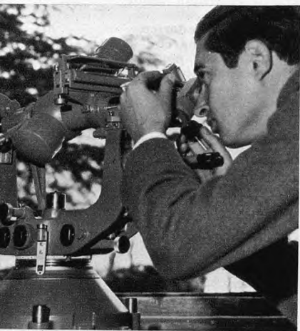
Teodolito T-4, utilizado en astronomía geodésica para la determinación de coordenadas astronómicas de alta precisión. Puede medir hasta la centésima de segundo.
