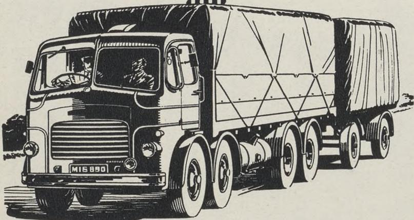
Modelo de 4 ejes, apto para 16/18 toneladas de carga útil
